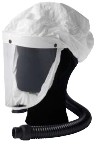
**Capucha SR 562** Capucha de poco peso que protege la cara y la parte superior de la cabeza. Intercambiable, fabricada de Tyvek y fácilmente ajustable en la cabeza. Se fabrica en un tamaño. Junta facial de poliamida/ lycra fácilmente ajustable. Mirilla de PETG. La SR 562 está homologada en la clase TH3, según EN 12941:1998.
