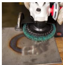
Quemaduras de soldadura
