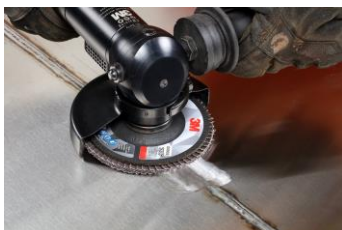
Desbaste de soldaduras
