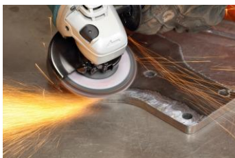
Limpieza de clamina
