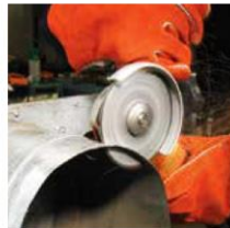
Discos de 1 mm Corte de precisión en chapa fina (<2mm)
